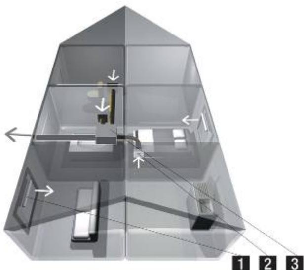
Предлагая переменный расход воздуха, адаптированный к потребностям помещений, регулируемое вентиляционное оборудование AEREKO уменьшает теплопотери, обеспечивает хорошее качество воздуха и предотвращает появление конденсата на стеклах и плесени на стенах. Разработанная компанией AEREKO гигрорегулируемая вентиляция является на сегодняшний день одной из передовых технологий в области регулируемой вентиляции.
