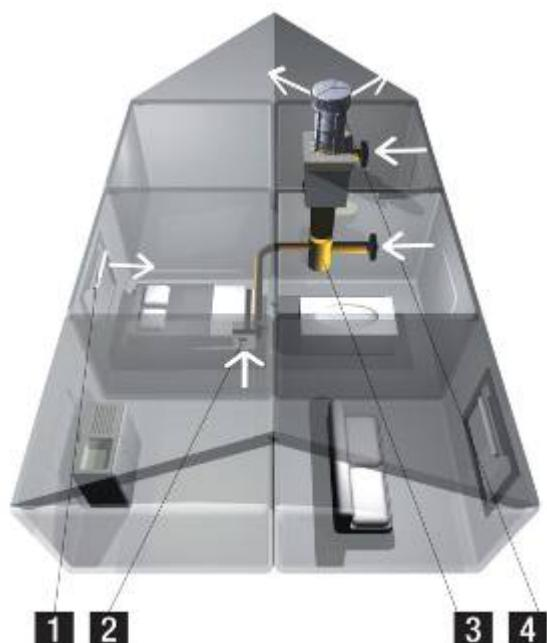
Предлагая переменный расход воздуха, адаптированный к потребностям помещений, регулируемое вентиляционное оборудование AEREKO уменьшает теплопотери, обеспечивает хорошее качество воздуха и предотвращает появление конденсата на стеклах и плесени на стенах. Разработанная компанией AEREKO гигрорегулируемая вентиляция является на сегодняшний день одной из передовых технологий в области регулируемой вентиляции.
